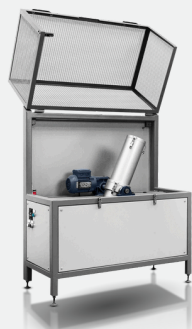
CSR - Koksoszilárdság redukció után I-tesztelő/tumbler
