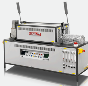
LTD - Alacsony hőmérsékletű redukció - vasérc bontása
