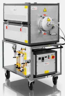
GLO 10/11-1G: Forno compacto de parede quente com retorta de aço inoxidável e retorta inonel opcional (vácuo até 750°C e sob pressão normal até 1100°C)
