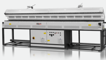
Projeto personalizado FZS 13/100/4500 de 3 zonas com comprimento aquecido de 4500 mm, abertura automática e tubo de trabalho APM
