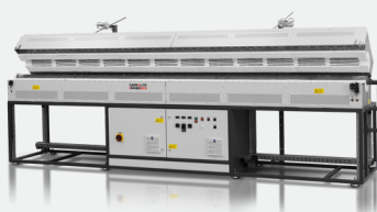
Op maat ontworpen 3-zone FZS 13/100/4500 met 4500 mm verwarmingslengte, geautomatiseerde opening en APM werkbuis
