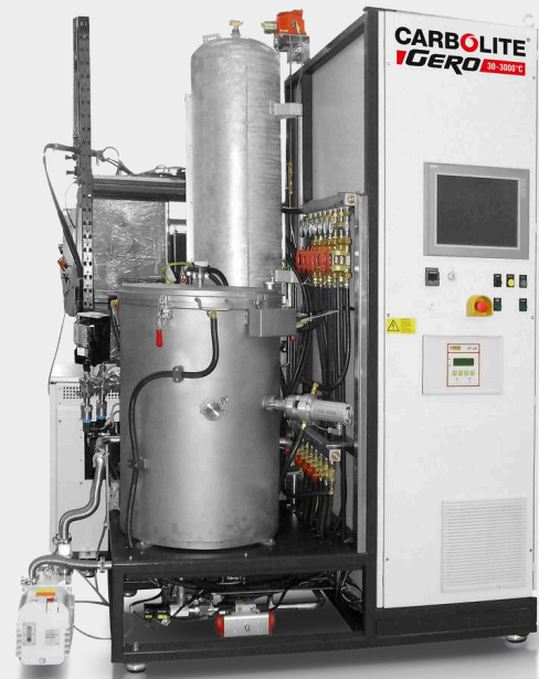
LHTW 200-300 / 22-IG automatická až do 2200 °C s možnosťou výbavy pre použitie vodíka
