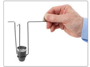
Štandardné drôtený držiak na téglik s téglikom & s viečkom (VFM / ASTM) - je súčasťou dodávky pece
