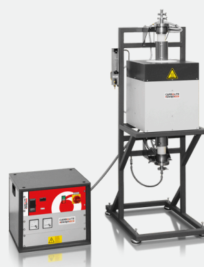
HTRV 18/70/250 cu pachet opțional de gaz inert, flanșe de vidare înaltă, programator E3508P10 și afișaj curent / tensiune
