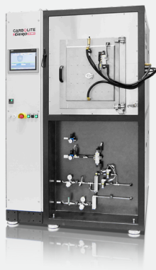
Piec HTK 8 GR/22-1G w wersji smart do temperatury 2200°C
