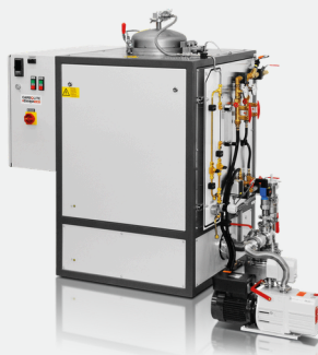
Piec VGLO z ładunkiem od góry 10/11-1G, manualny do 1100°C z opcjonalną pompą próżniową (750°C max.)
