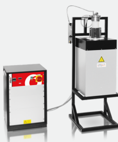
HTRV 18/100/500 с опциональным пакетом для работы в среде инертного газа и керамической трубкой, закрытой с одной стороны
