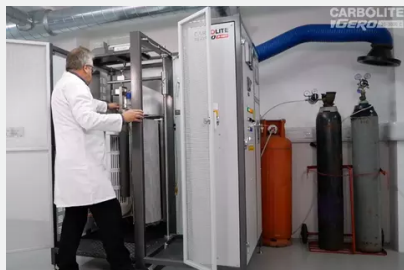
IOR - 鉄鉱石還元性試験炉・紹介動画
