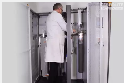
CRI - コークス反応性試験炉・紹介動画
