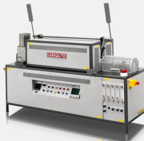
LTD - Riduzione a bassa temperatura - Disintegrazione del minerale di ferro
