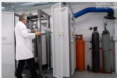
IOR - Horno para determinar la reducibilidad del mineral de hierro
