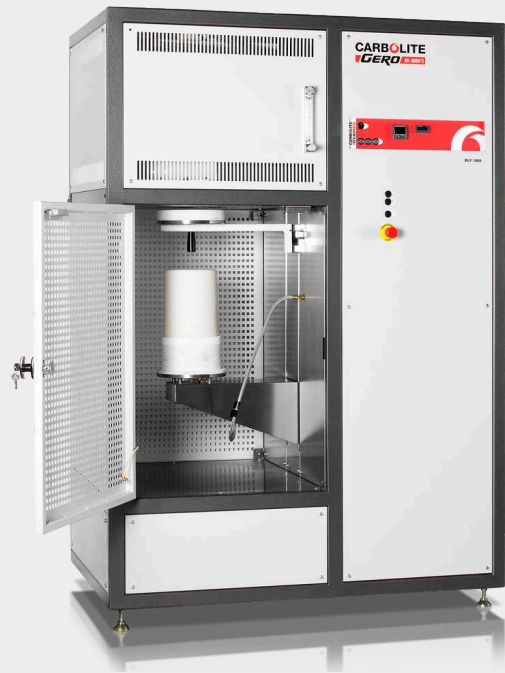
BLF 18/8 con crisol invertido, caudalímetro y disco de protección térmico opcionales
