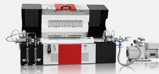
FZS 13/70/500 paquete de gas inerte para Ar y gas reactivo O 2 equipado con bomba rotativa de paletas de doble etapa
