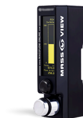
Contrôle du débit de gaz par un débitmètre numérique
