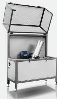
CSR - Résistance du coke après réduction I-Testeur/tambour rotatif
