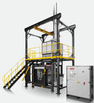
MWO 227 kg – Four pilote de cokéfaction à parois mobiles
