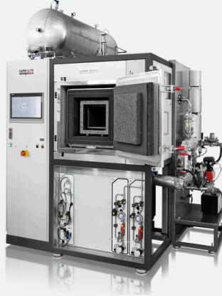
HTK 25 GR/22-1G automatik bis 2200°C mit optionalem Pyrolyse-Paket
