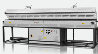
Four personnalisé à 3-zones FZS 13/100/4500 avec 4500 mm de longueur chauffée, ouverture automatique et tube de travail APM
