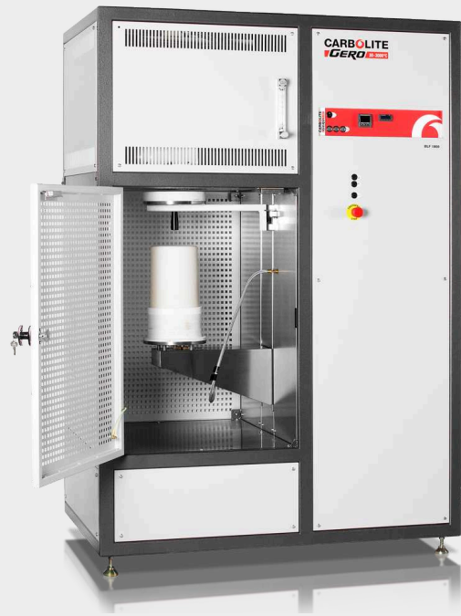
BLF 18/8 mit optionalem Durchflussmesser und Gaseinlass, umgekehrtem Tiegel sowie Strahlungsschutz
